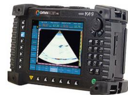
非破壊検査装置
